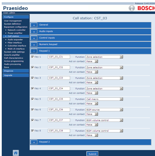
rys. 43.28: Konfiguracja stacji wywoławczej, krok 7
