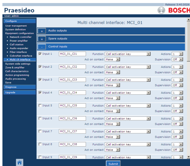
rys. 43.43: Wejścia sterujące interfejsu wielokanałowego
