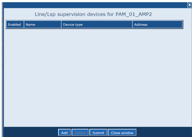
rys. 43.14: Dodawanie urządzenia nadzoru, krok 1
