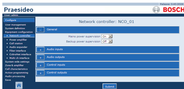
rys. 43.4: Konfiguracja sterownika sieciowego, krok 3
