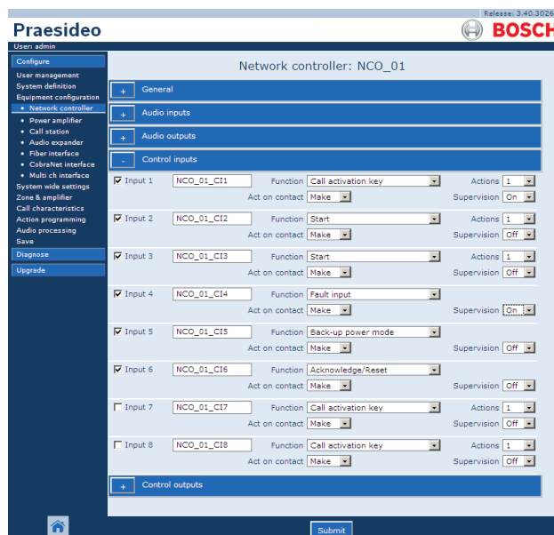
rys. 43.7: Konfiguracja sterownika sieciowego, krok 5
