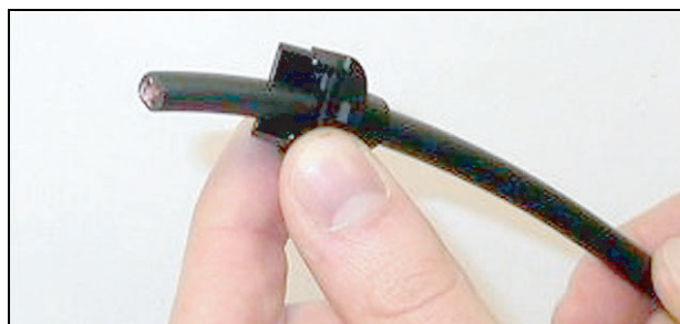
rys. 29.6: Tylna obudowa na kablu
