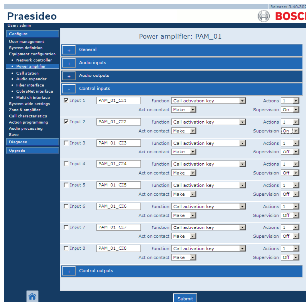
rys. 43.18: Konfiguracja wzmacniacza mocy, krok 6
